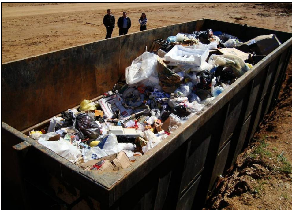
Foto 5 - Contêiner para armazenamento temporário de RSU no município de Aceguá.
