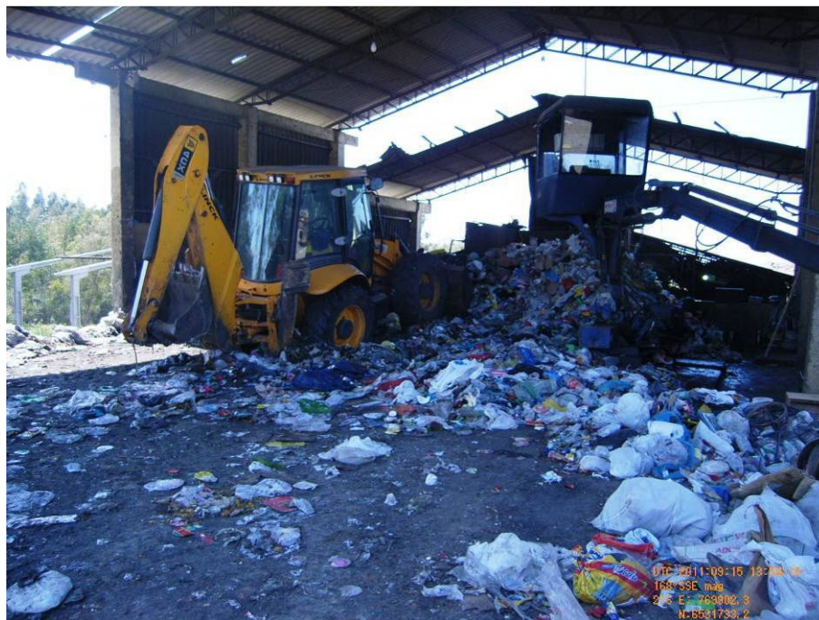
Foto 16 - Outra vista do pavilhão de recebimento de resíduos urbanos na Central de Triagem de resíduos do município de Bagé. Destaque para o procedimento de transferência do resíduo, para o pavilhão de triagem.
