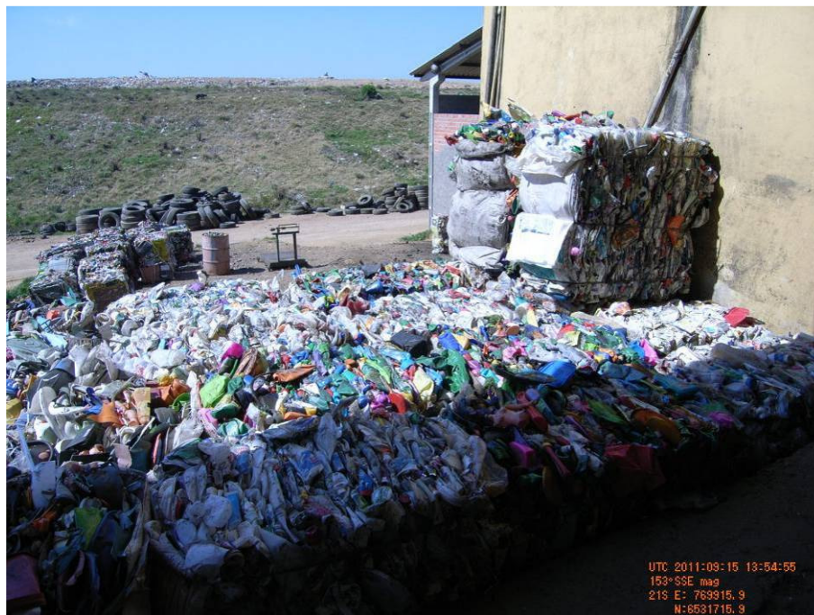
Foto 22 - Vista do material após o processo de triagem e compactação dos resíduos. Detalhe da organização das pilhas de resíduos prontos para comercialização.
